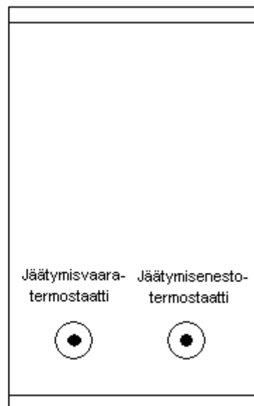
Joonis 4. Parmair KxVO jäätumisohu- ja jäätumist takistav termostaat
